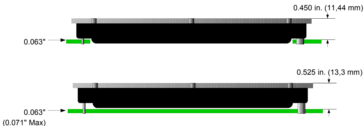
Рис.1 Методы монтажа: а) «в плату» - применяются модули с укороченными выводами б) «на плату» - применяются модули с удлиненными выводами
