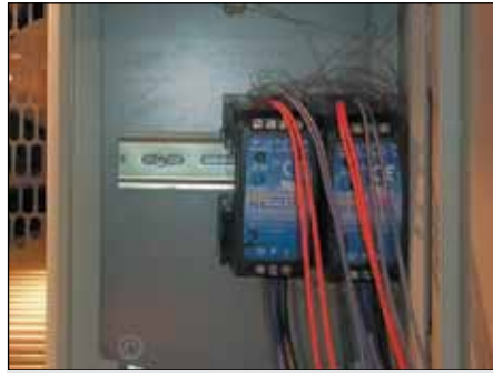
Рис. 5. Два источника питания REDIN, проходящих цикл испытаний при 85 °С и 95%-ной влажности воздуха в течение 1000 ч
